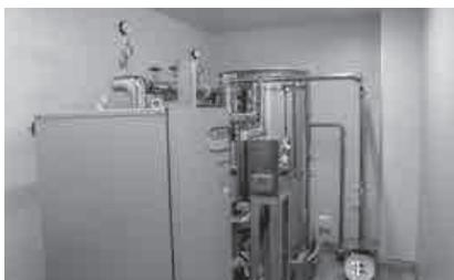
ソフトカプセル等の製造に最も必要なのは“水”。この機械で地下からくみ上げた地下水をさらに浄化し真水にします。
