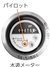
水道メーター
